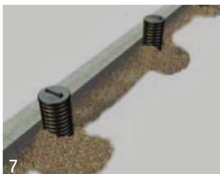
7 Betten Sie die schrägen Stahlstreben in Drainagesplitt der Größe 8/16 und stabilisieren Sie den Stahlrahmen. Verschließen Sie die Manschette und richten Sie den Griff des Deckels im rechten Winkel zur Mauer aus. Der Griff des Deckels dient als Orientierung für das Achsmaß zur nächsten SLEEVE-IT Manschette, um einen gleichmäßigen Abstand der einzelnen Zaunpfosten zu erreichen.
