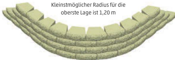
Die unten stehende Tabelle zeigt den geringstmöglichen Radius der unteren Steinreihe für verschiedene Mauerhöhen. Der kleinste Radius der oberen Reihe ist 1,20 m.
