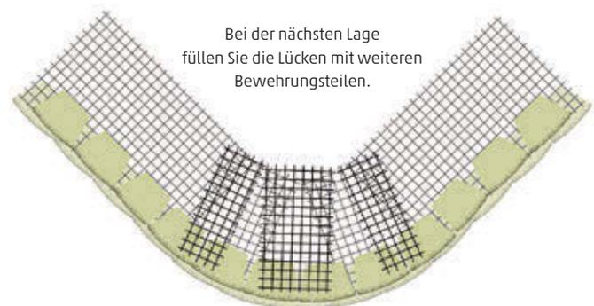
Stellen Sie sicher, dass die mit Geogitter laut Abschnitt Einbau mit Bewehrung auf S. 66 gebaut sind.
