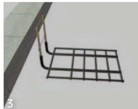
3 Stellen Sie den PVC-beschichteten Stahlrahmen mit einem Abstand von etwa 15 cm zur Mauer so auf, dass die beiden Stahlstangen nach oben zeigen.
