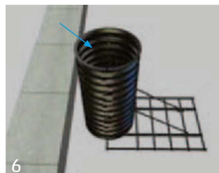
6 Justieren Sie bei Bedarf den bisherigen Aufbau, indem Sie den oberen Querriegel in der Manschette anheben. Stellen Sie sicher, dass die Mauerneigung der verbleibenden, noch zu mauernden Steinreihen berücksichtigt wird, wenn Sie die Manschette in ihre endgültige Position bringen.
