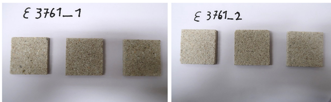
Bild 1: Betonsteinproben mit und ohne Color Protect Ausrüstung.
