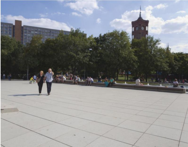
Bei diesem Bauvorhaben hat der Auftraggeber einen Gleit-Rutsch-Widerstand mit einem SRT-Wert  $> 60$  vorgegeben. Eine speziell entwickelte Beschichtung konnte diesen Anforderungen gerecht werden. Trotz erhöhter Rauigkeit der Oberfläche bleibt die Beschichtung RSF 5 pflegeleicht und zeigt bei Bewitterung einen sehr guten Reinigungseffekt.
