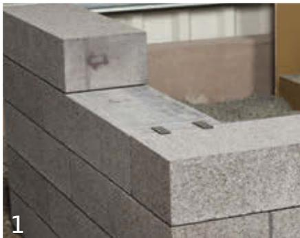
Alternativ zur Mauerabdeckung können Sie für den Mauerabschluss den Abdeckstein und für Ecken die Kombisteine verwenden. Kombisteine stehen in drei Formaten mit für alle Platzierungen bearbeiteten Kanten zur Verfügung. Achten Sie bei der Auswahl der jeweiligen Stein darauf Kreuzfugen zu vermeiden.
