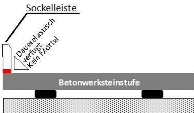
Sockelleisten nicht direkt auf Betonwerksteinstufen setzen!
